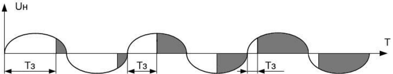
Рисунок 3.3 Выходное напряжение при фазовом способе регулирования
