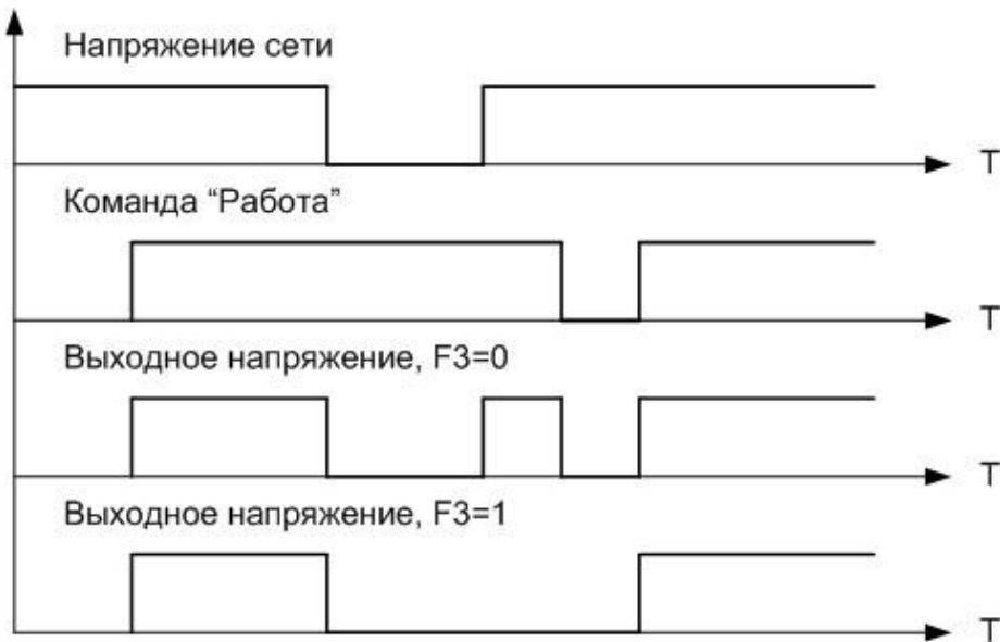
Рисунок 3.3 Применение функции F3
