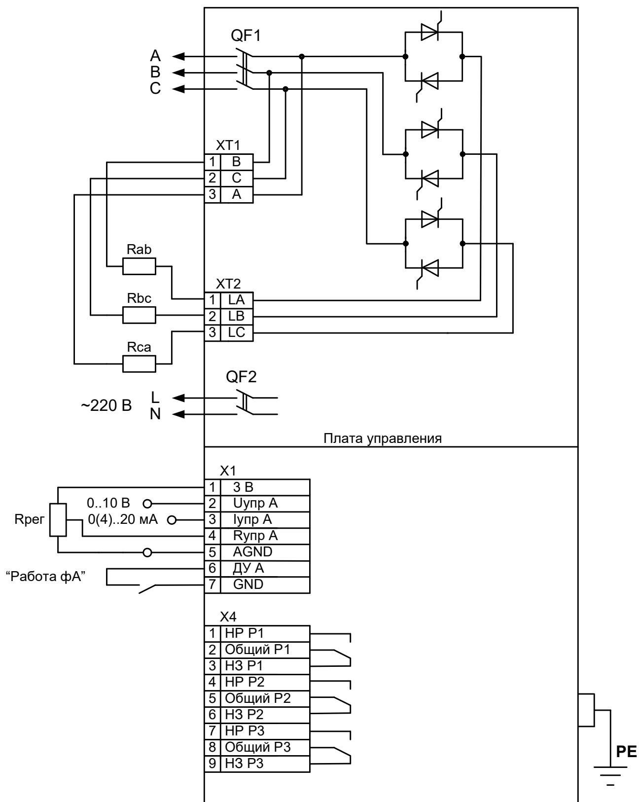
Приложение Б Схема расключения ПИД-регулятора
