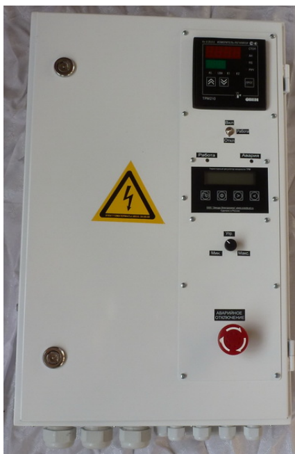
Рисунок 3.1 Внешний вид выпрямителя
