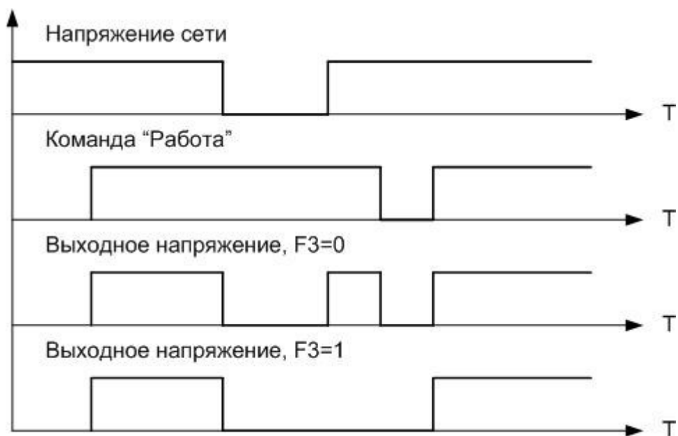
Рисунок 3.2 Применение функции F3
