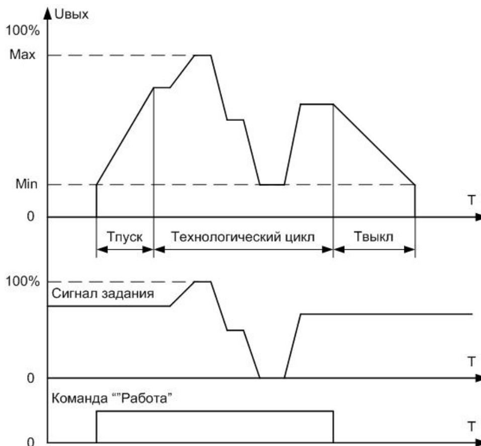
Рисунок 3.5 Рабочий цикл при фазовом методе регулирования
