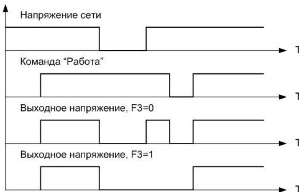
Рисунок 3.3 Применение функции  $F3$
