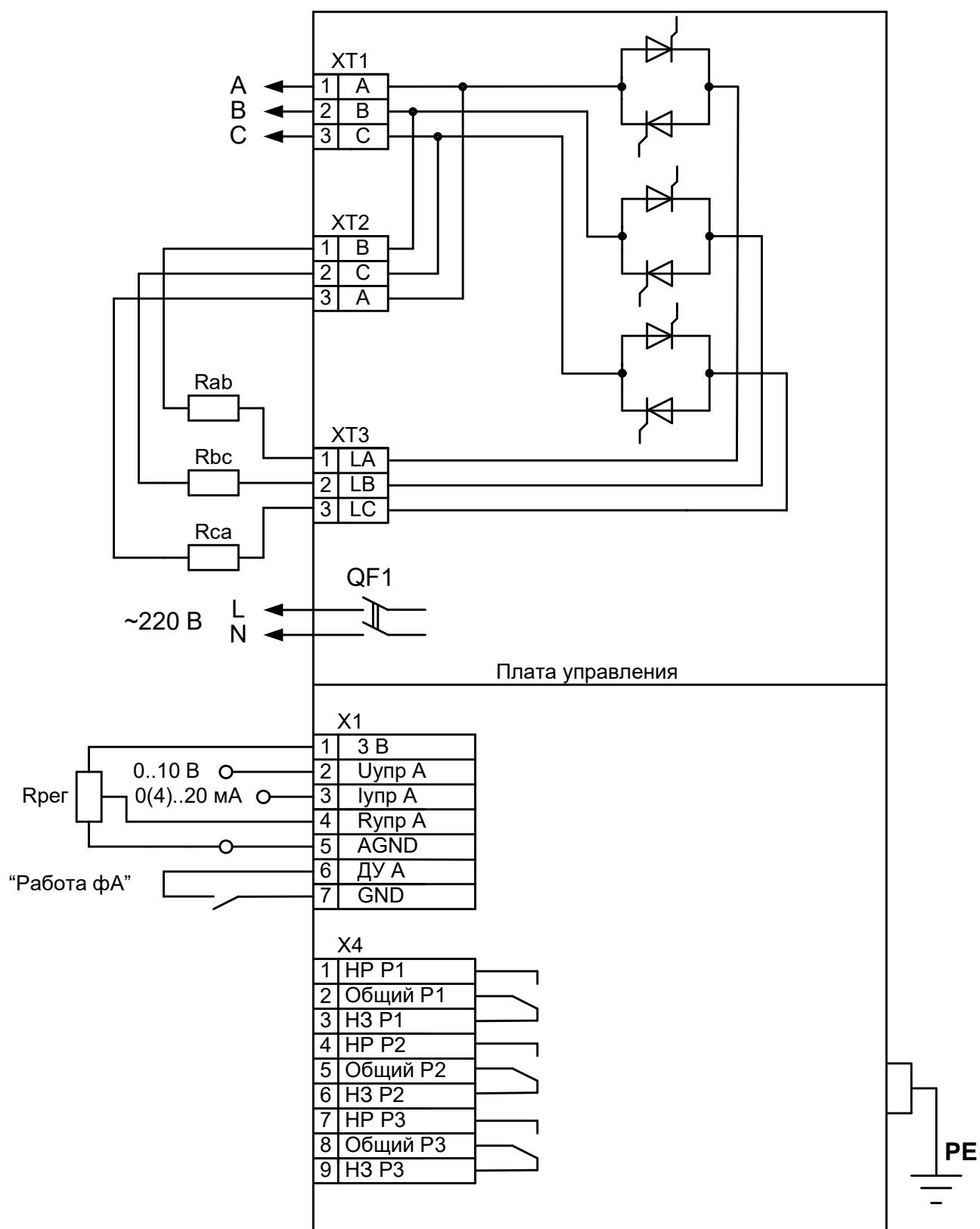
Рисунок А1 Схема подключения нагрузки – разомкнутый “треугольник”
