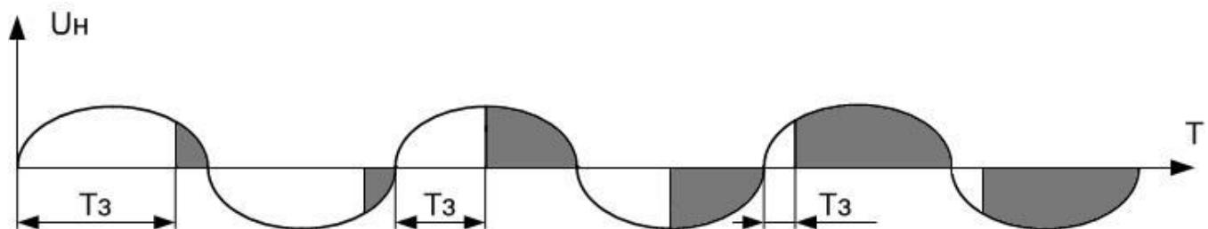
Рисунок 3.4 Выходное напряжение при фазовом способе регулирования
