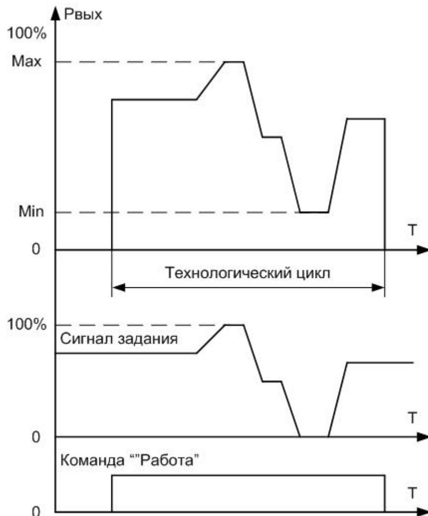
Рисунок 3.7 Рабочий цикл при регулировании методом пропуска периодов
