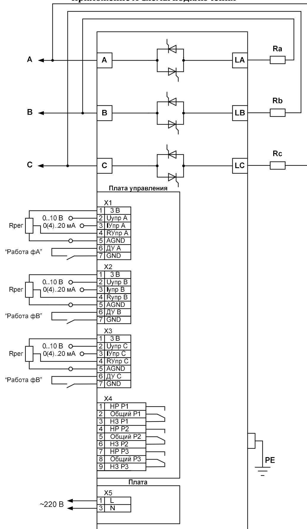
Рисунок А1 Схема подключения, нагрузка – разомкнутый треугольник
