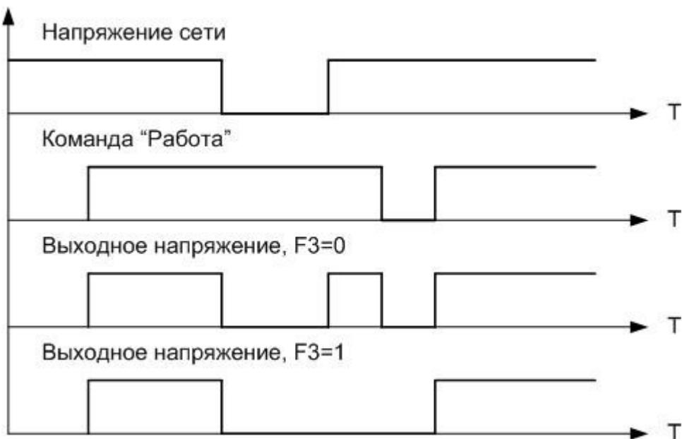
Рисунок 3.3 Применение функции F3
