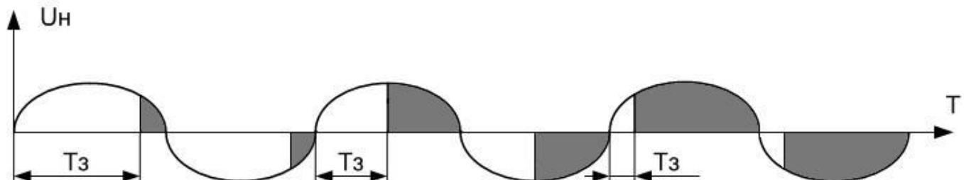
Рисунок 3.4 Выходное напряжение при фазовом способе регулирования
