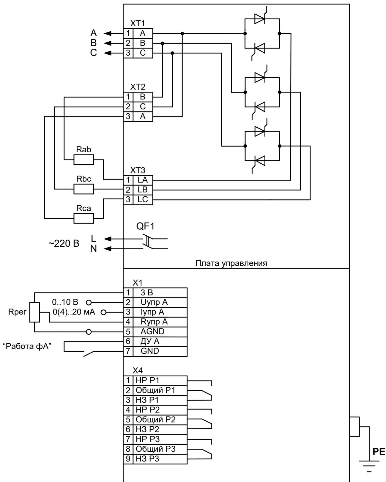
Рисунок А1 Схема подключения нагрузки – разомкнутый "треугольник"
