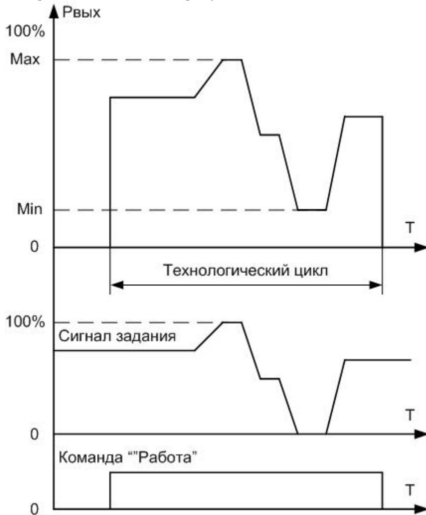
Рисунок 3.6 Рабочий цикл при регулировании методом пропуска периодов
