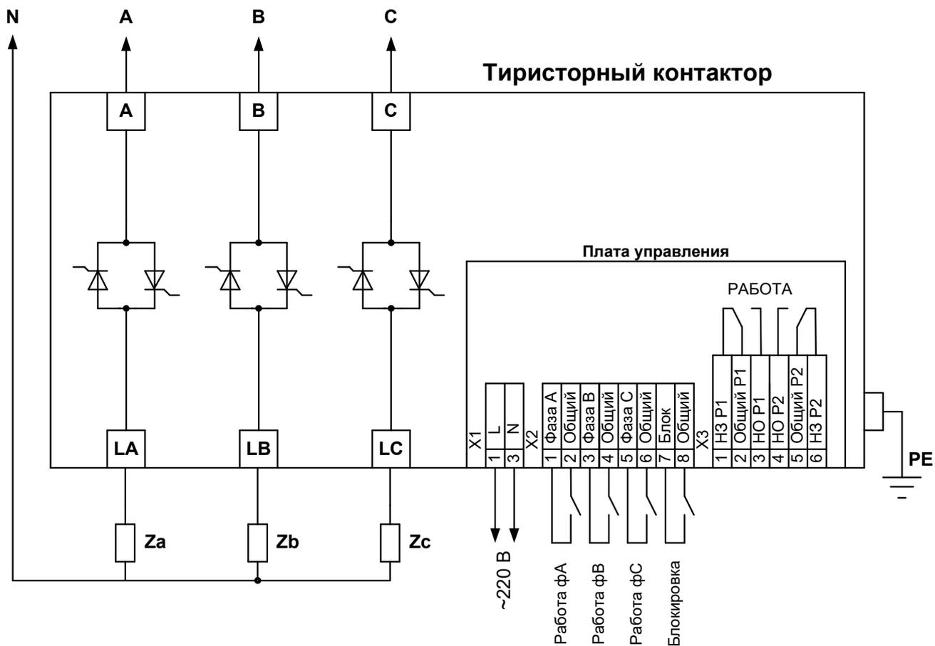
Рисунок А2 Схема подключения, нагрузка - "звезда" с рабочей нейтралью.
