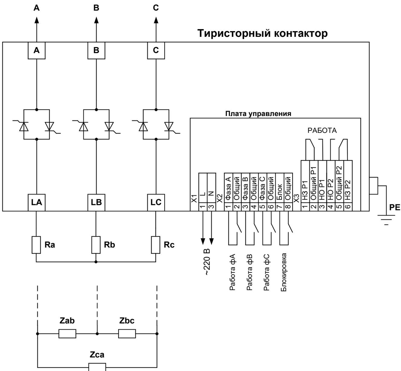
Рисунок А1 Схема подключения, нагрузка - "звезда" или "треугольник". Управление фазами - совместное
