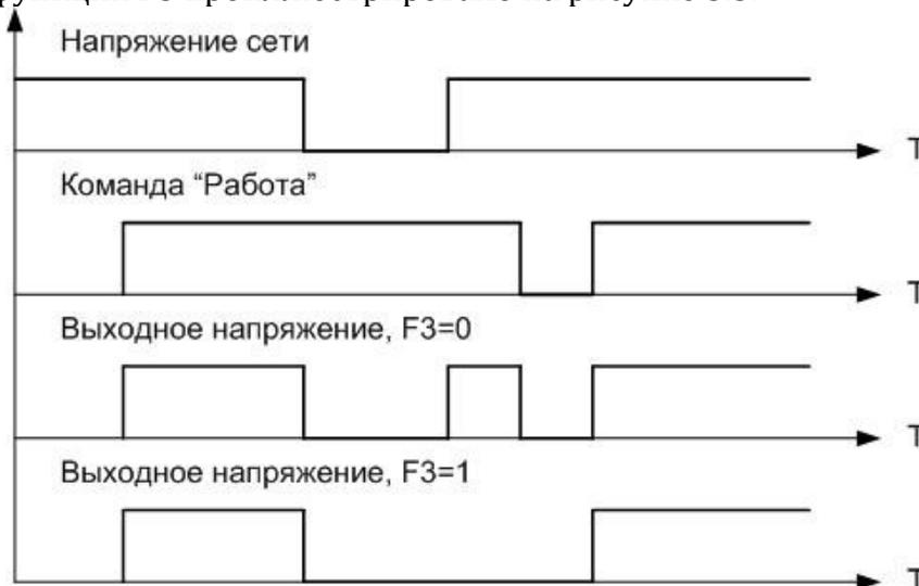
Рисунок 3.3 Применение функции F3
