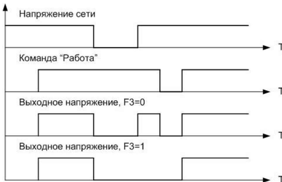
Рисунок 3.2 Применение функции F3
