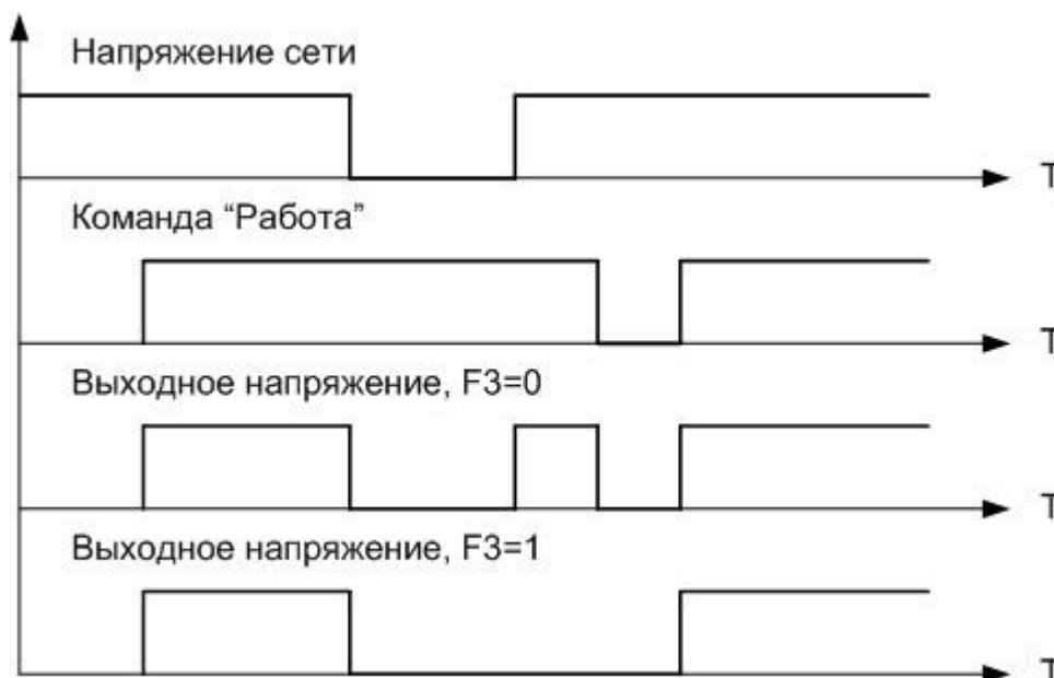
Рисунок 3.2 Применение функции F3
