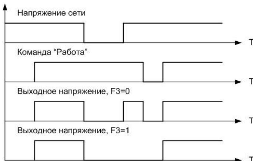
Рисунок 3.3 Применение функции F3
