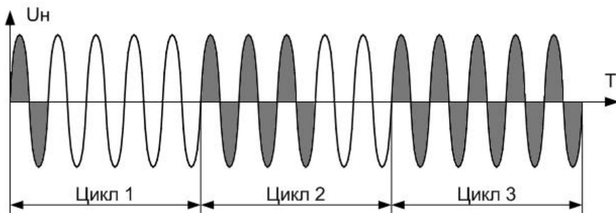
Рисунок 3.6 Выходное напряжение при регулировании методом пропуска периодов
