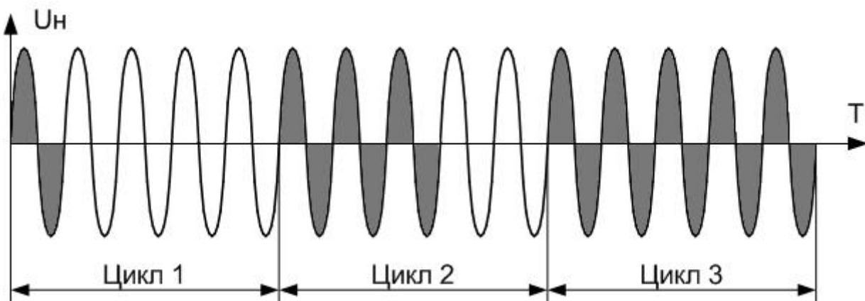
Рисунок 3.5 Выходное напряжение при регулировании методом пропуска периодов
