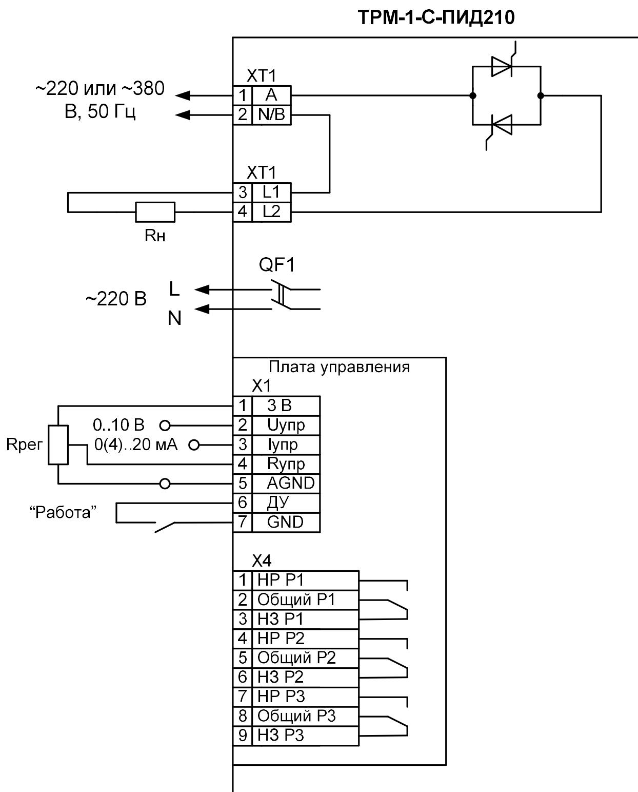
Рисунок А1 Схема подключения внешних проводок
