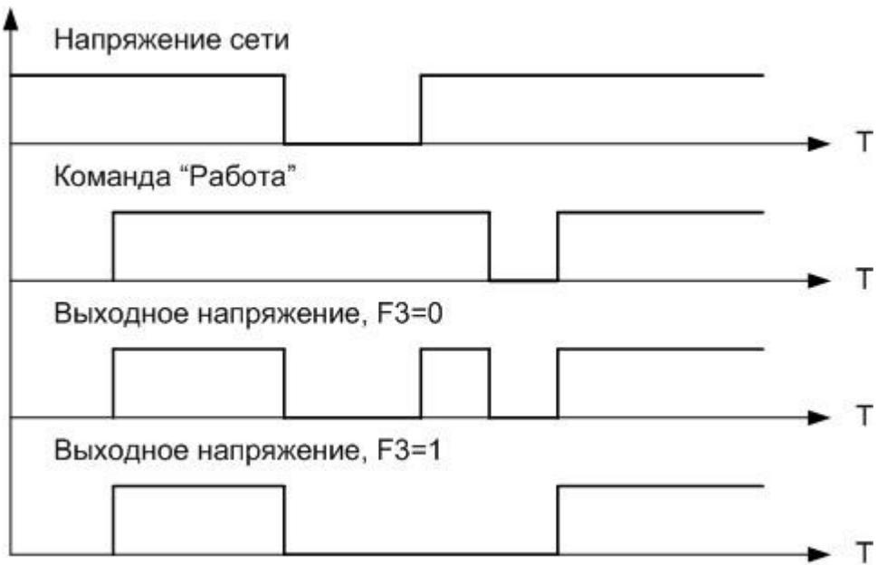
Рисунок 3.3 Применение функции F3
