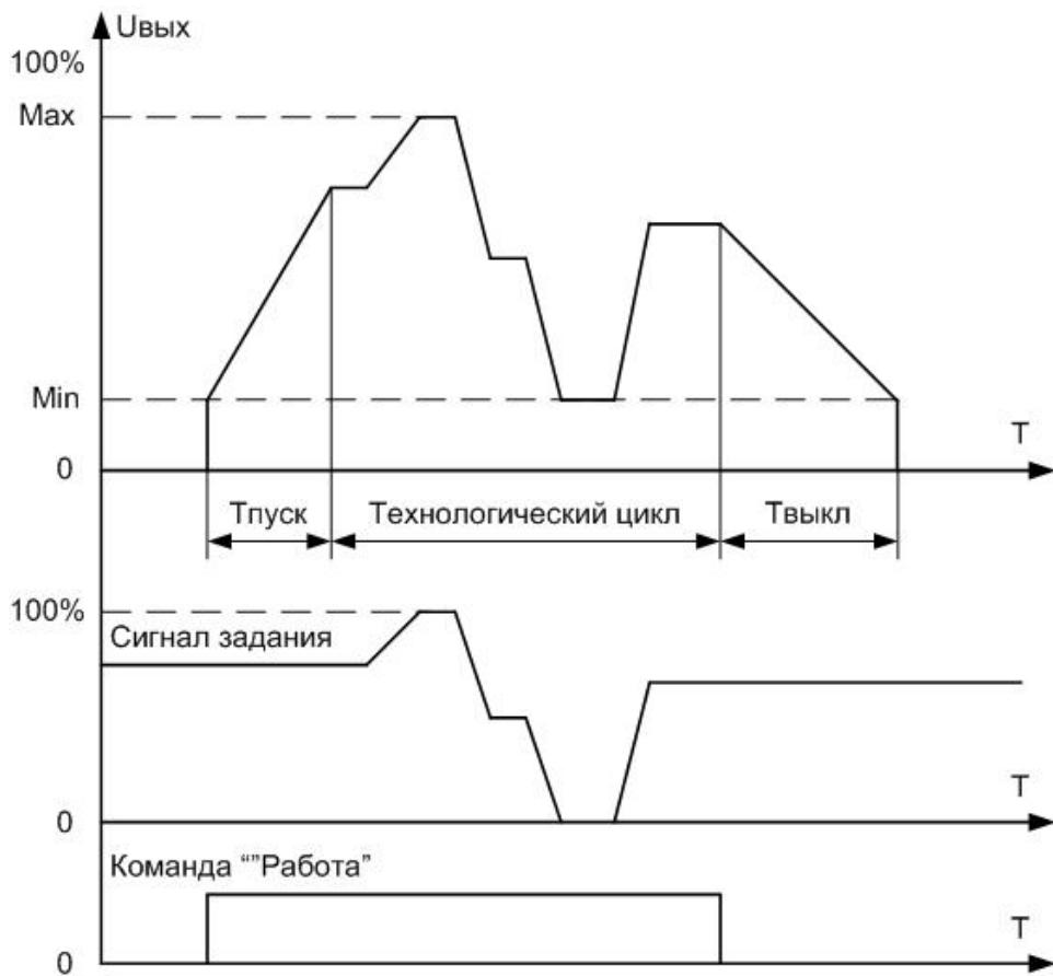
Рисунок 3.5 Рабочий цикл при фазовом методе регулирования
