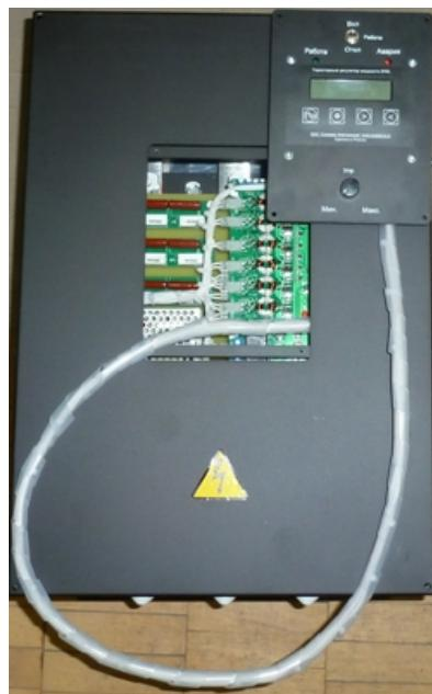
Рисунок 3.2 Регулятор ZVEL с вынесенной панелью управления
