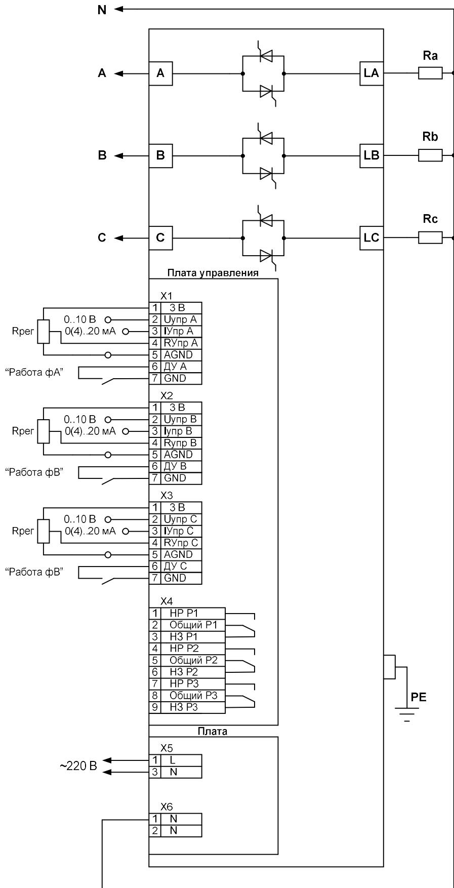
Рисунок А1 Схема подключения, нагрузка - “звезда” с рабочей нейтралью.
