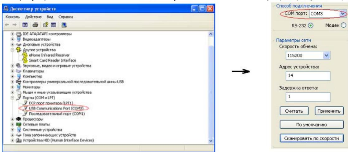
**Рисунок 4.2 – Порядок установки драйвера виртуального COM-порта**
