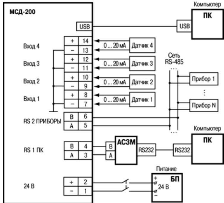
Рисунок Б.1 – Подключение к модулю внешних устройств
