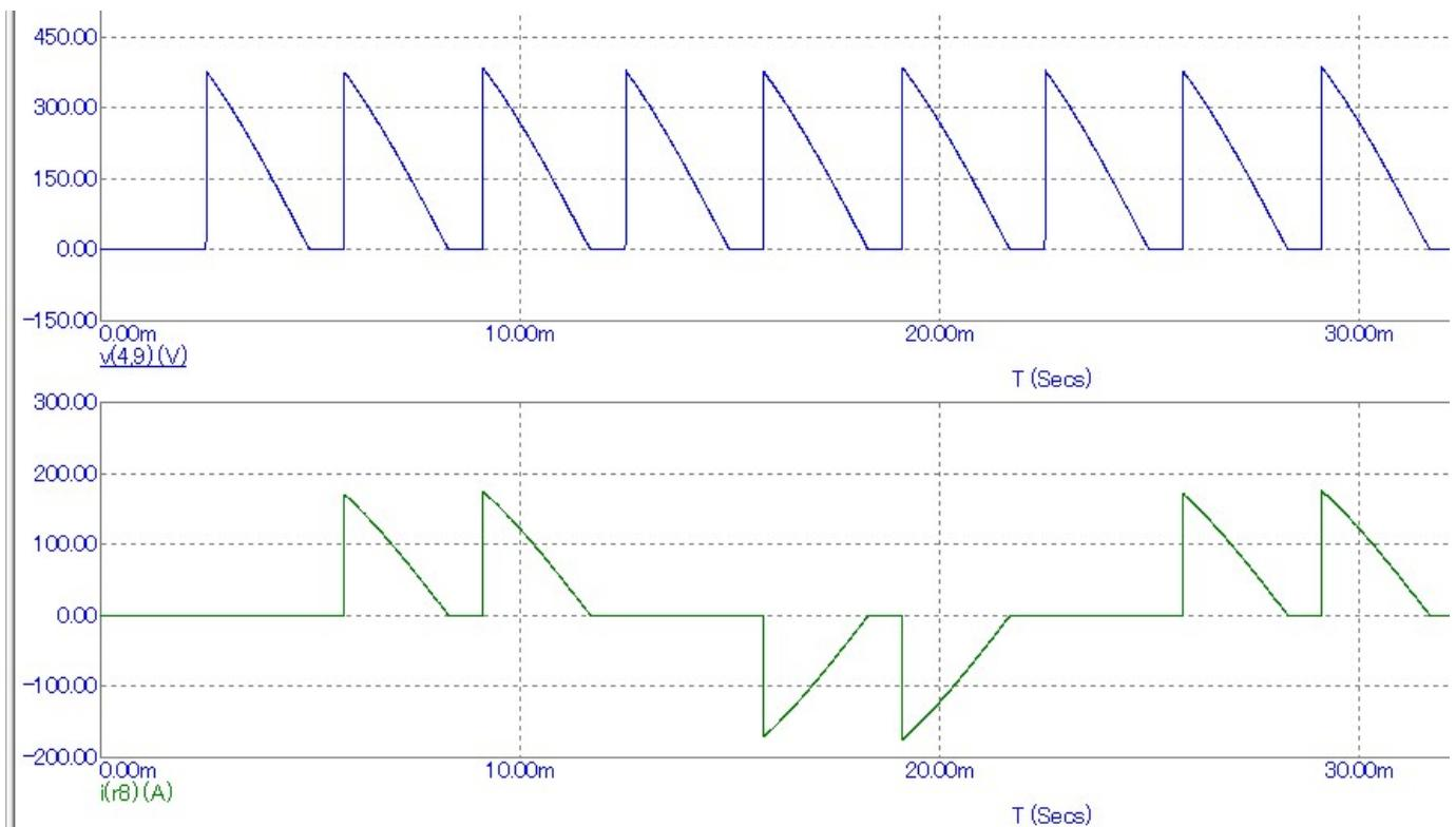
Рисунок 3.2 Выходное напряжение выпрямителя(вверху) и ток в фазе(внизу)
