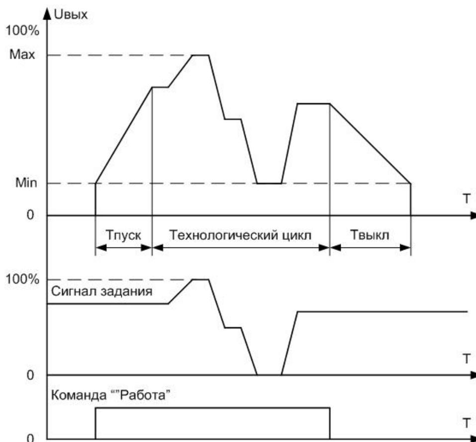
Рисунок 3.4 Рабочий цикл при фазовом методе регулирования
