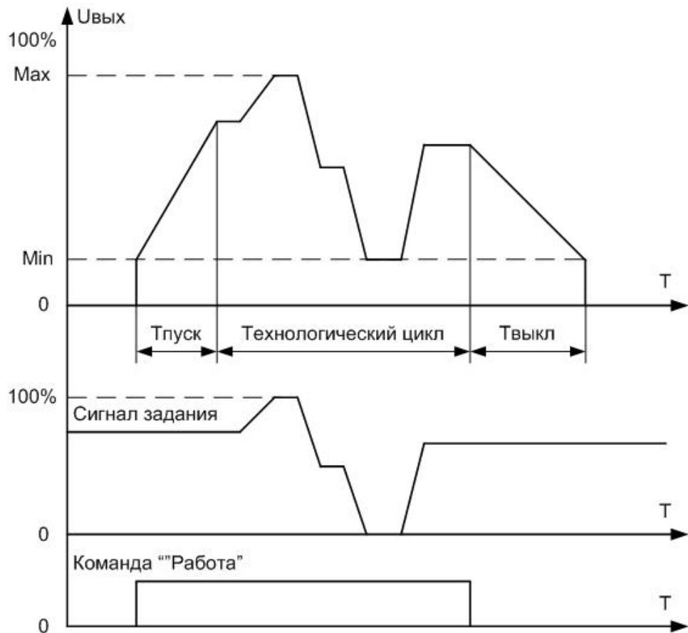
Рисунок 3.4 Рабочий цикл при фазовом методе регулирования
