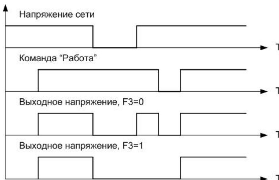
Рисунок 3.2 Применение функции F3
