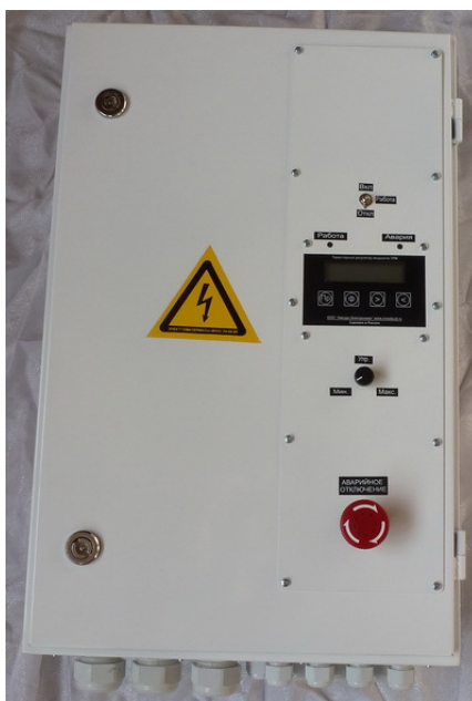
Рисунок 3.1 Внешний вид выпрямителя
